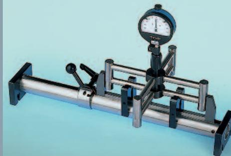
Einstellgerät für OD Kreuzhülse/ Kufenkreuzhülse
